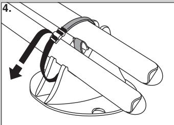
Die Skier mit den Skispitzen in Fahrtichtung nach hinten in die untere Skihalterung einlegen und mittles den Spannriemchen festzurren. **Nach erfolgter Montage den Festzitz der Skier in Fahrtichtung kontrollieren und gegebenenfalls nachspannen.**
