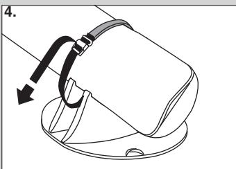
1 oder 2 Snowboards in die Skihalterung einlegen (das Snowboard mit grösserem Spitzradius in Fahrtichtung nach hinten) und mit dem Spannriemchen festzurren. **Nach erfolgter Montage den Festzitz der Snowboards in Fahrtichtung kontrollieren und gegebenenfalls nachspannen.**
