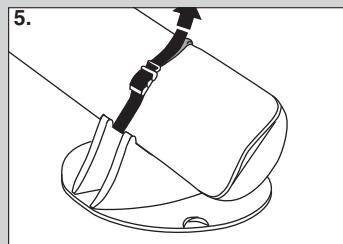
Appoggiare 1 o 2 snowboard sul supporto (con il lato più largo opposto al senso di marcia) e fissateli con le cinghie di dotazione. **A montaggio avvenuto controllate se gli snowboard sono montati stabilmente; se necessario, stringete ancora le cinghie.**
