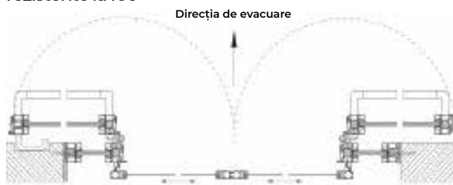
Figura 18. Soluție pentru construcția ușilor glisante rezistente la foc
