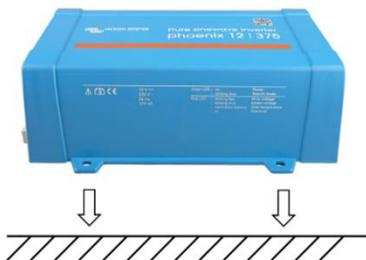
Montirajte pretvarač pomoću četiri zavrtnja vertikalno prema gore ili prema dolje ili horizontalno prema gore ili prema dolje (kao što je prikazano na slici 1) uz čvrsti zid ili horizontalno na odgovarajuću podlogu (kao što je prikazano na slici 2). Održavajte najmanje 4 inča (10 cm) razmaka u odnosu na druge aparate/predmete. Imajte na umu da se IP21 odnosi samo na donju metodu montaže prikazanu na slici 2; inače se primjenjuje IP20. **Nemojte montirati pretvarač naopako na površinu.**
