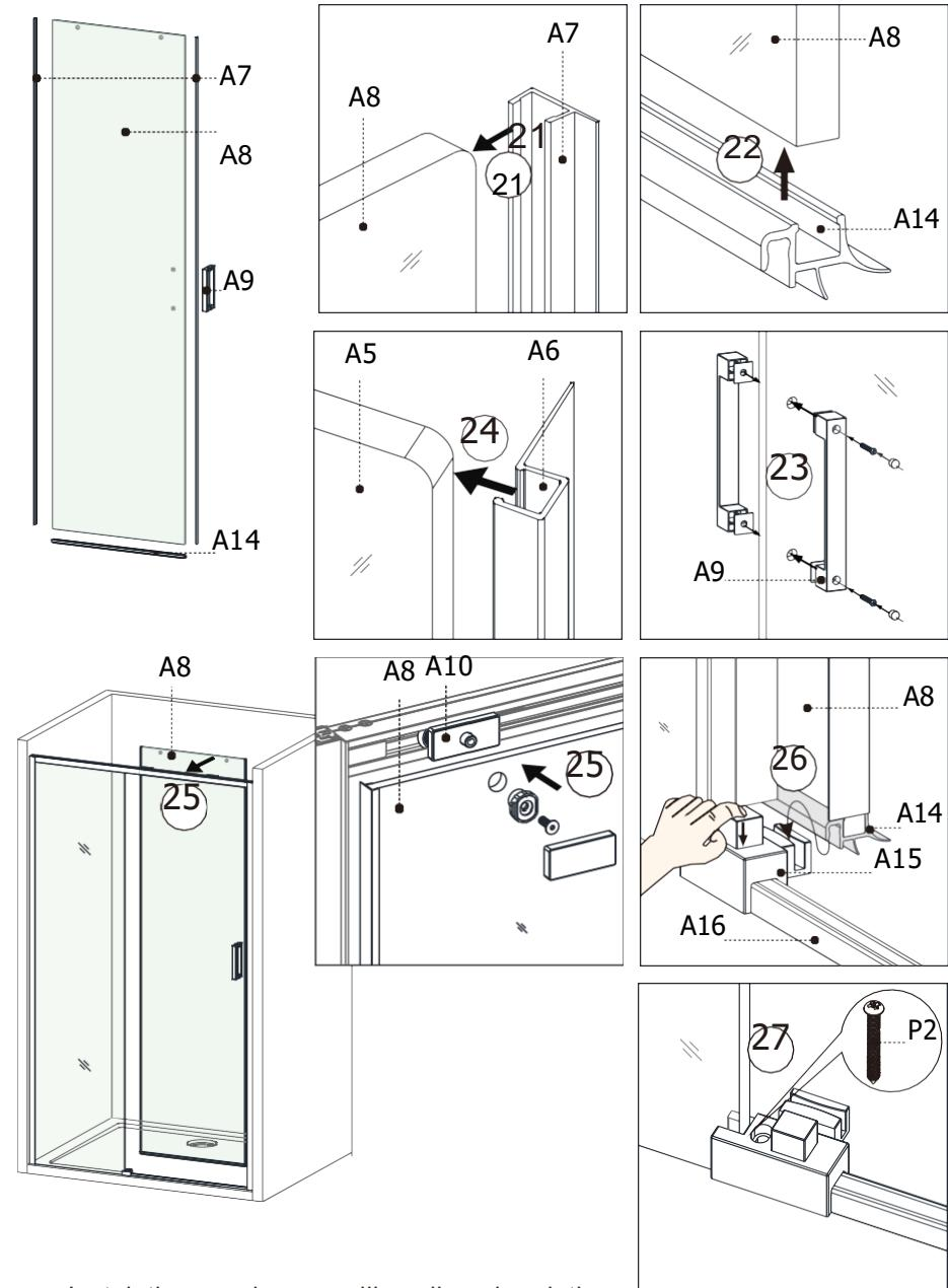
4.1) Instalati pe rand accesoriiile usii apoi reglati usa culisanta din sticla introducand rotile pe sina/
