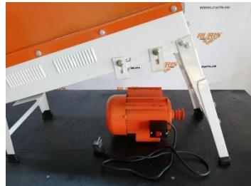
6. Прикрепете задвижващия ремък на позиция, след това подравнете ролката на двигателя с ролката на барабана. Закрепете двигателя, като здраво затегнете винтовете.
