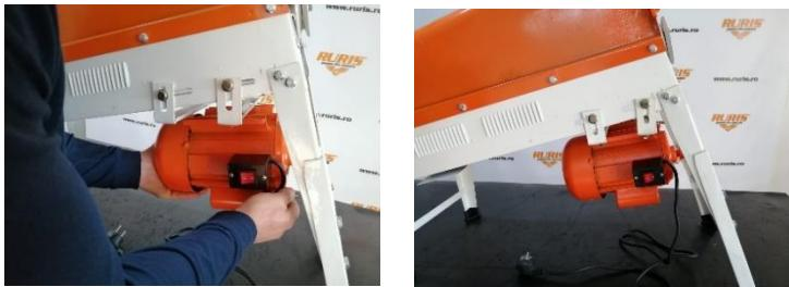
5. Se atașează motorul și se fixează în șuruburi fără a se strângă.
