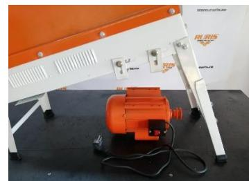
6. Pričvrstite pogonski remen na mesto, a zatim poravnajte remenicu motora sa remenicom bubnja. Pričvrstite motor tako što će vrsto zategnuti zavrtanje.
