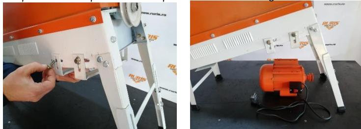
6. Se atașează cureaua de transmisie pe poziție, după care se aliniază fulia motorului cu fulia tamburului. Se fixează motorul, prin strângerea fermă a șuruburilor.
