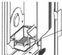
Daca orificiile arzatorului sunt pline cu impuritati, acesta trebuie deschis si curatat.
