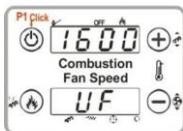
**UF** = Viteza ventilatorului [RPM/Volt]
