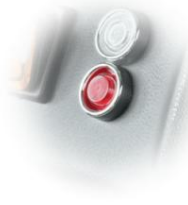
INDICATOR DE ÎNFUNDARE A FILTRULUI Martorul luminos este înfundat sau trebuie înlocuit.
