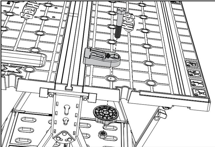
Installez la base du serre-joint d'établi de la façon illustrée. Alignez l'écrou hexagonal sur l'encastrement du bouton et serrez ce dernier en vous assurant de placer l'écrou dans l'encastrement. L'écrou reste en place pour une utilisation ultérieure.
