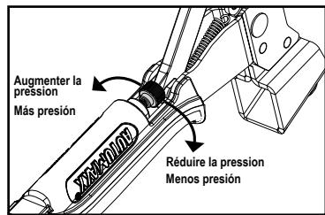
Pour augmenter la pression du serre-joint, tournez la vis à tête moletée vers la gauche (lorsque vu de l'extrémité de la poignée du serre-joint) ou vers la droite pour la réduire.
