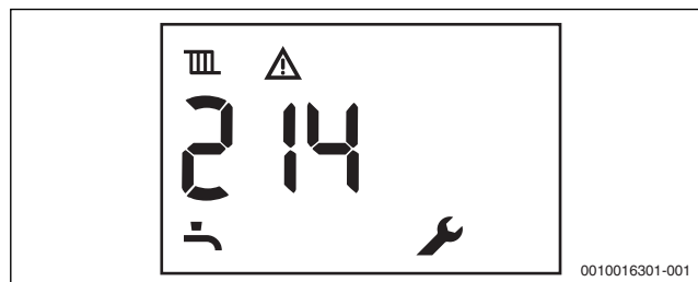
Fig. 69 Exemplu: defecțiune care nu determină blocare
