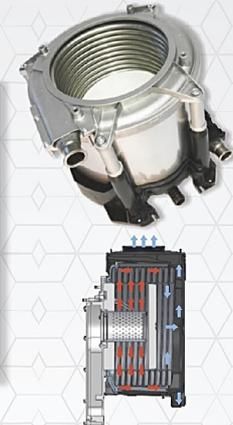
Noul schimbător de căldură ce echează centrala CONFORT KPLUS, este un schimbător de căldură integrat și compact, cu o singură serpentină din oțel inoxidabil, cu secțiune ovală. Schimbătorul de căldură este compus dintr-o cameră de ardere cu o zonă de ardere, o zonă de condensare și un disc metallic izolat, care separă cele două zone.
