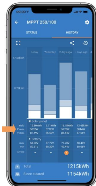
Citire istoric Pmax în aplicația VictronConnect.
