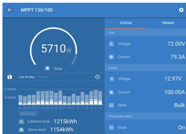
Captură de ecran cu aplicația VictronConnect, cu afișarea datelor în timp real și a datelor istorice.
