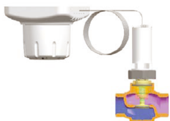
Temperatura din încăperea sub valoarea prestabilită, robinet închis
