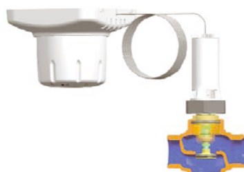
Temperatura din încăperea peste valoarea prestabilită, robinet deschis
