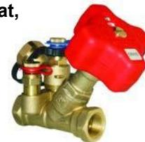
Corp din alamă rezistentă ladezincare, mufe cu filet interior, etanșarea tijei cu garnitură dublă tip O-Ring, reglare preliminară prin limitarea cursei, roată de manevră cu indicator de poziții cu digiți.
