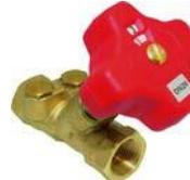
Corp din alamă rezistentă la dezincare, mufe cu filet interior, etanșarea tijei cu garnitură dublă tip O-Ring, reglare preliminară prin limitarea cursei, roată de manevră cu indicator de poziții cu digiți.
