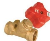
Corp din alamă rezistentă la dezincare, mufe cu filet interior, etanșarea tijei cu garnitură dublă tip O-Ring, reglare preliminară prin limitarea cursei, roată de manevră cu indicator de poziții cu digiți.
