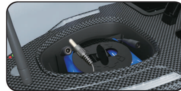
Podłączanie akumulatora Podłącz interfejs komory akumulatora, gdy używasz
