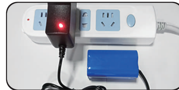
Interfejs ładowania akumulatora Podłącz akumulator do ładowarki Czerwone światło: Ładowanie Zielone światło: Zakończone
