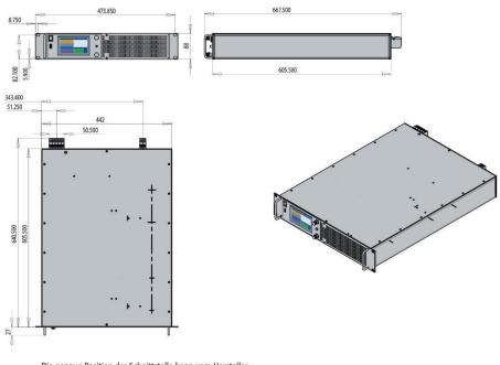
Die genaue Position der Schnittstelle kann vom Hersteller aufgrund verschiedener Geräteparameter geändert werden. The exact position of the interface can be changed by the manufraturer due to different device paramteters.
