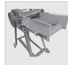
Шаг 9: Установите конвейерную ленту и отрегулируйте, используя шурупы-костыли. Убедитесь, что гайки на середине двухугольного винта настроены правильно. Способ установки одинаков с обеих сторон.
