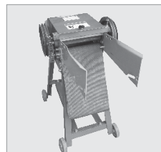
Стъпка 7: Инсталирайте страничните панели на конвейера, като отбележите разликите. За повече подробности, моля, вижте основната страница с ръководство.
