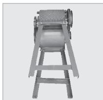
Шаг 3: Следуя предыдущим шагам, установите нижний Н-образный кронштейн с выходной стороны и верхний Н-образный кронштейн со стороны подачи корма.
