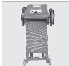
Шаг 6: После сборки инструмента убедитесь, что он установлена ровно, затем заблокируйте все винты на Н-образных кронштейнах. Толкните инструмент, чтобы проверить его стабильность; она не должна качаться.
