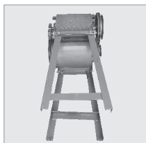
Стъпка 3: Следвайки предишните стъпки, монтирайте долната Н-скоба от страната на изхода и горната Н-скоба от страната на захранването.
