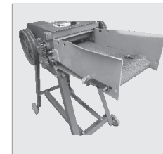
Стъпка 9: Инсталирайте транспортната лента и регулирайте с помощта на винтовете на патерицата. Уверете се, че гайките в средата на винта с двойна глава са регулирани правилно. Методът на монтаж е еднакъв от двете страни.
