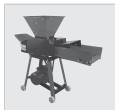
Шаг 15: Установите левый щит. Для кормоизмельчителей с загрузочным бункером добавьте бункер только после завершения всех этапов установки.
