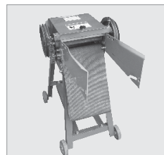
Шаг 7: Установите боковые панели конвейера, обратив внимание на различия. Для более подробной информации обращайтесь к главной странице руководства.
