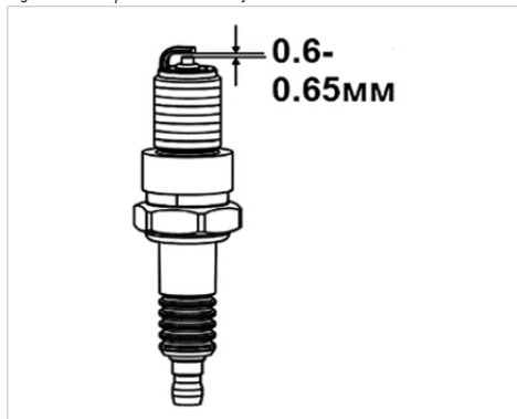
Figura 20. Întreținere tehnică a bujiei
