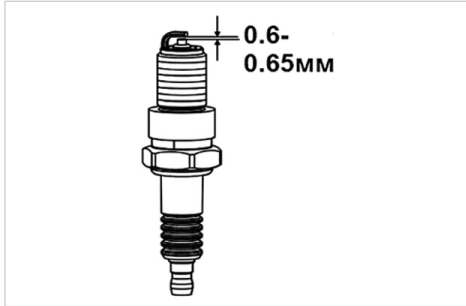
Мал. 20 Обслуговування свічки запалювання
