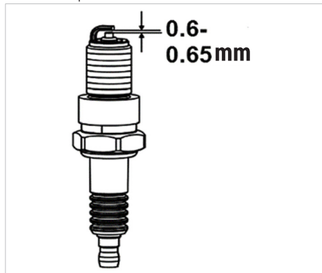
Obr. 20 Servis zapalovacích svíček
