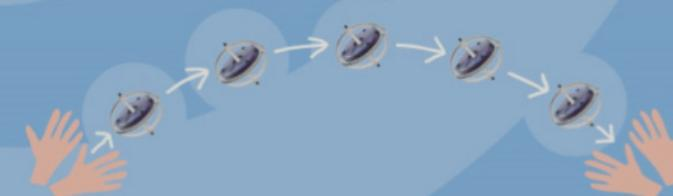
**Precesiune giroscopică** - Dacă o forță este aplicată unui giroscop rotativ, axa acestuia nu se mișcă în aceeași direcție cu forța, ci în unghi drept față de aceasta.
