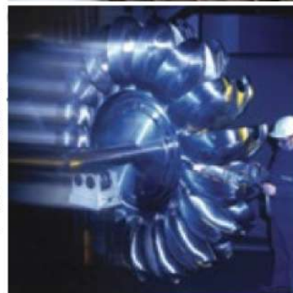
Un curent de apă de înaltă presiune antrenează această turbină Pelton într-o centrală electrică.
