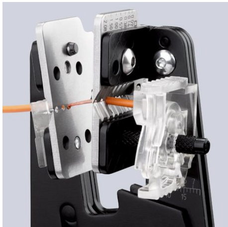
dezizolare prin apăsare #i blocare pe forma piesei datorită profilelor precise ale cu#itelor
