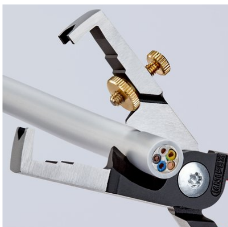
Lamã de sec#ionare cãlitã prin induc#ie cu #lefuire de precizie pentru tãierea fãrã strivire a cablurilor din cupru #i aluminiu de pãnã la Ø 15 mm (5 x 2,5 mm 2 )
