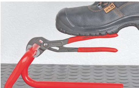
Dinții deplasati în sens contrar celui de rotație generează un efect de prindere automată și diminuează alunecarea de pe piesă.
