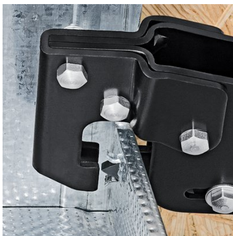
scula de poansonare este ap#sat# prin profilele de tabl#
