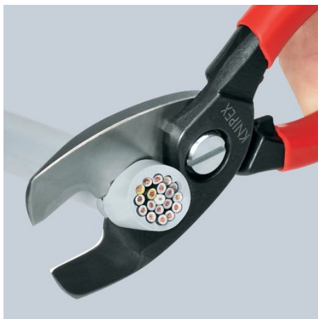
Tăiere ulterioară: după ce a fost tăiat înveli#ul cablului cu ajutorul profilului frontal, sunt sectiona#i conductorii pe profilul posterior. Tăiere prealabilă în fa#a - tăiere ulterioară în spate - a#a se taie mai ușor.
