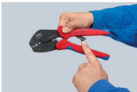
Închideți maneta de service și apăsați cleștele până la capătul de cursă - cleștele este pregătit pentru următoarea utilizare
