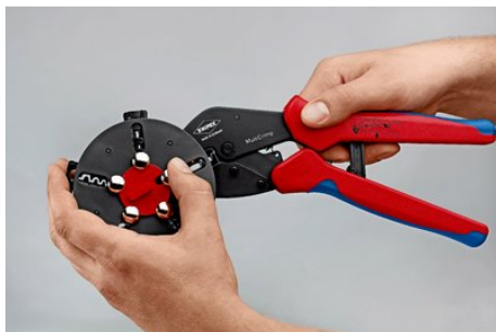
Schimbarea adaosului de sertizare: deblocați poziția magaziei, prindeți adaosul de sertizare în fălcile cleștelui
