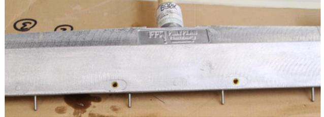
Le réglage du racloir à manche doit être supérieur de 1 à 2 mm à l'épaisseur de couche souhaitée.
