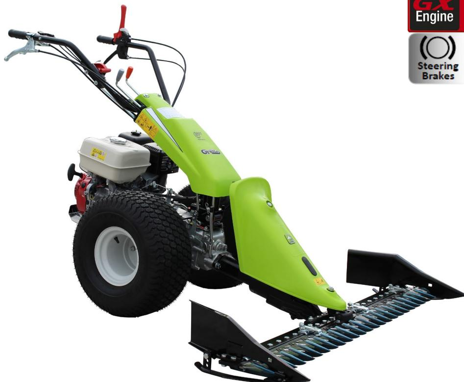
Motocositoarea GF3DF ALPINE este special concepută pentru utilizare pe pante înclinate de până la 30° datorita motorului profesional HONDA GX340 HIGH INCLINATION și a dotărilor speciale ale motocositoarei:
