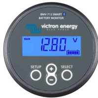
BMV-712 Smart Battery Monitor BMV-712 Smart Battery Monitor ili SmartShunt omogućava punjenje kompenzirano temperaturom i naponom. Informacija o struji punjenja baterije može se, na primjer, koristiti za prebacivanje s apsorpcionog punjenja na plivajuće punjenje pri podešenoj struji na kraju baterije.
