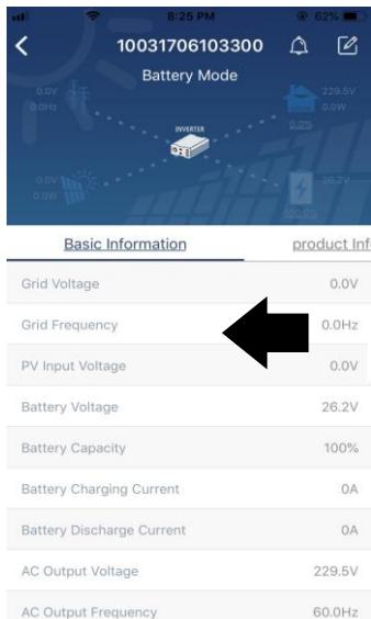
**【Osnovne informacije】** prikazuje osnovne informacije o pretvaraču, uključujući AC napon, AC frekvenciju, PV ulaz napon, napon baterije, kapacitet baterije, struja punjenja, izlazni napon, izlazna frekvencija, izlazna prividna snaga, izlazna aktivna snaga i postotak opterećenja. Povucite prema gore da vidite više osnovnih informacija.
