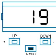
Zur Speicherung des geänderten Werts 1 Sekunde lang die Taste MENU drücken, bis der Wert dauerhaft angezeigt wird, oder zum schnellen Verlassen ohne Speicherung kurz MENU drücken.
