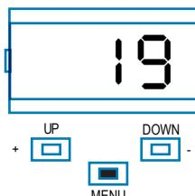
Premer a tecla MENU durante 1 segundo até visualizar o valor de forma fixa para guardar o valor modificado ou MENU rapidamente para sair sem guardar.
