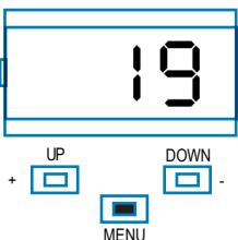
Wcisnąć i przytrzymać przez 1 sekundę przycisk MENU, aż do wyświetlenia niemigającej wartości, co oznacza jej zapisanie. Aby wyjść bez zapisywania wartości, wcisnąć szybko przycisk MENU.
