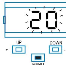
Um die Wertänderung zu öffnen, 1 Sekunde lang die Taste MENU drücken, bis der Wert schnell blinkt.
