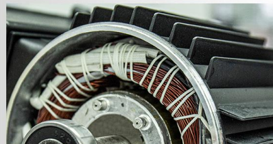
Carcasa motorului din aliaj de aluminiu
