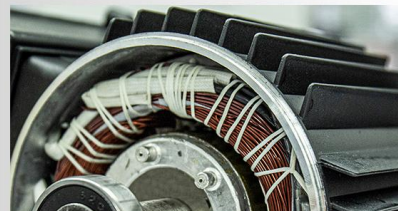
Carcasa motorului din aliaj de aluminiu
