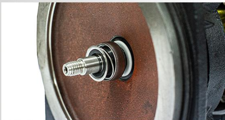
Garnitura mecanică: ceramică/grafit/NBR
