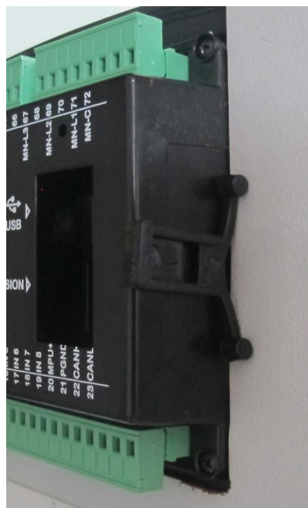
Instalarea suportului tip auto-reținere
