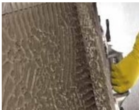
Verificarea acoperirii cu adezivul Kerabond T-R pe spatele plăcii ceramice - acoperire totală de 100%
