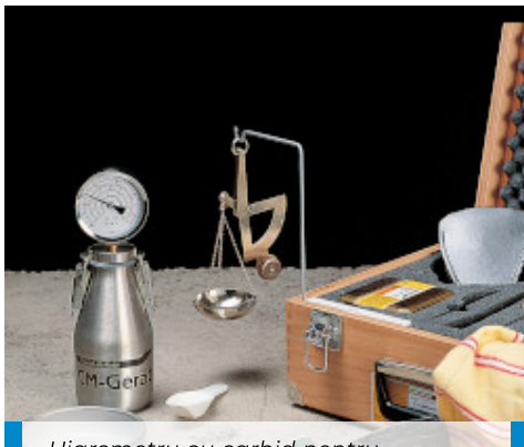
Higrometru cu carbid pentru masurarea nivelului de umiditate al unei sape Mapecem
