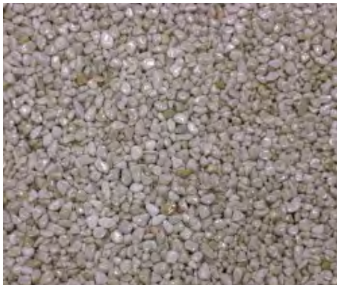
Aplicarea amestecului de agregate naturale + Mapecrete I 910
