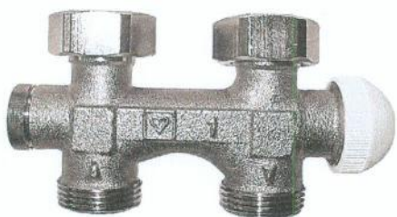
HERZ-3000-Piesă de legătură (by-pass) cu robinet termostatic încorporat, pentru instalații monotubulare - model drept.
