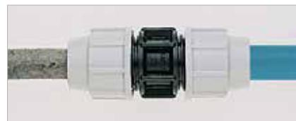
**Indepartati** piulita de pe fitting si scoateti inelul despicate alb. Introduceti piulita pe teava, iar apoi inelul maro si inelul de etansare.
