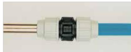
**Impingeți** capatul de teava in corpul fittingului. Asigurati-vă ca introduceti teava cel putin pana la marcajul pe care l-ati facut. Impingeți ambele inele pana la flansa insertiei si insurubati piulita. Utilizati cheia Plasson pentru strangerea finala a piulitei.
