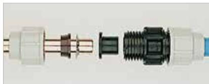
**Taiati** drept teava. Indepartati bavurile. Asigurati-vă ca teava este fara zgarieturi, indoituri si alte asemenea imperfecțiuni. Scoateti piulita din fitting, impreuna cu inelul despicate. Marcati teava pana la adancimea la care se introduce insertia de cauciuc. Asamblati piulita, inelul maro si inelul de otel pe teava in aceasta ordine. Asigurati-vă ca inelele maro si inelele de otel inoxidabil sunt pozitionate inspre corpul fittingului.
