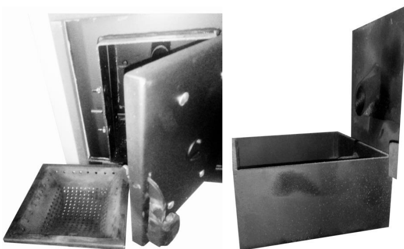
Figura 16. Curățarea carcasei arzătorului și a arzătorului cu aspiratorul
